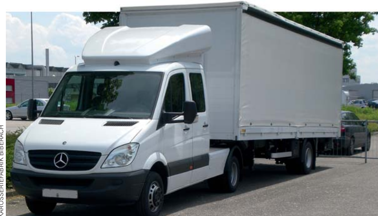
Der etwa 7,3 m lange Pritschensattel SBC-6,5 LLB mit Ladebordwand eignet sich für Transporte leichter und großvolumiger Baustoffe. Als Zugmaschine dient ein auf 3,5 t abgelasteter Sprinter 518 (519) CDI, den die Karosseriefabrik Biberach zur Sattelzugmaschine umgebaut hat und der deshalb mit der Fahrerlaubnis Klasse BE bewegt werden darf.
